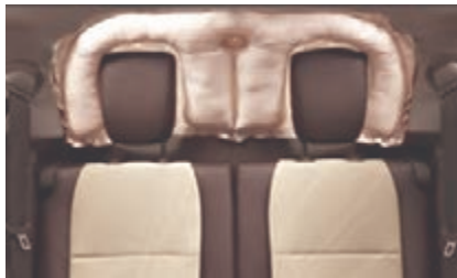
شکل ۶۰- عملکرد کیسه‌های هوای ایمنی برای حفاظت از سرنشین در برخورد از عقب
