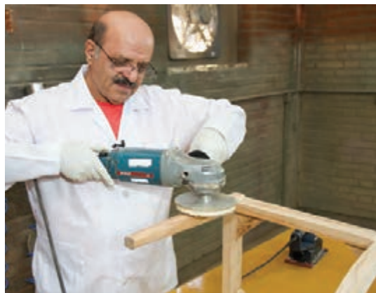
شکل ۲۵- دستگاه سنباده گرد یا دیسکی
