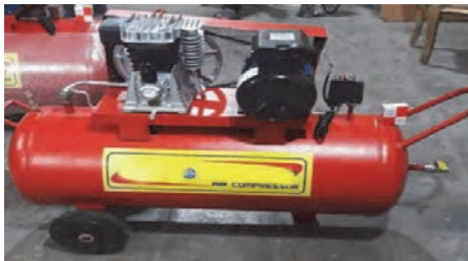
شکل ۱۹۰- هیچ‌گاه کمپرسور را به پهلو نخواستابانید
