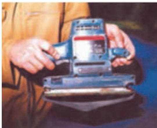
شکل ۴۷- شل شدن کاغذ سنباده
