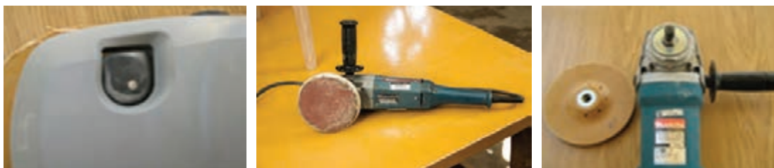
شکل ۱۷۴- اجزای سنباده دیسکی
