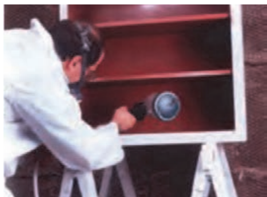
شکل ۲۳- رنگ کاری قسمت های داخلی
