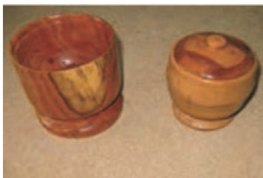
شکل ۷۳- نمایانی الیاف در رنگ غیر پوششی
