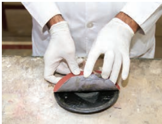
شکل ۱۷۶- چسب زدن به کاغذ سنباده
