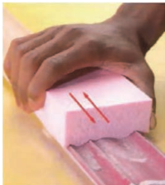
شکل ۱۰۸- تخته سنباده برای قطعه افزار خورده
