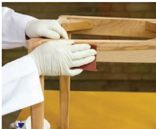
شکل ۱۲- سنباده کاری در جهت الیاف
