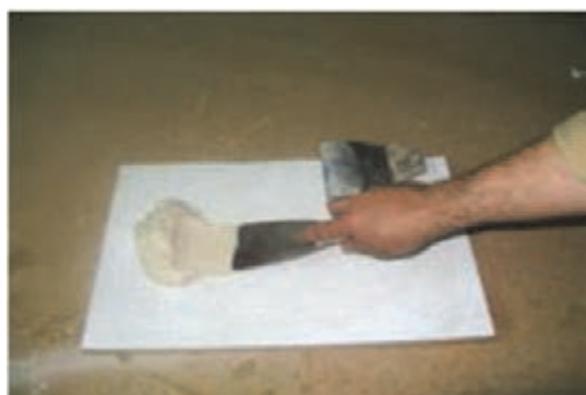
شکل ۱۳۹- تخته بتونه برای ساخت بتونه
