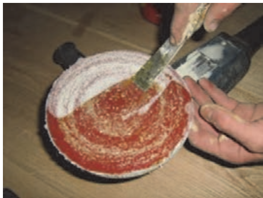
شکل ۱۷۷- چسباندن کاغذ سنباده به سنباده دیسکی
