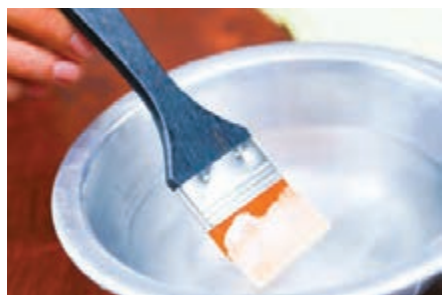
شکل ۳- شستن قلم‌مو با حلال به روش صحیح
