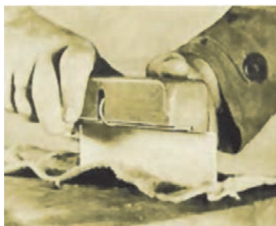
شکل ۶۲- مصقل کشی در لیسسه با رنده مصقل
