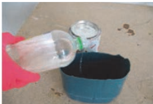
شکل ۸۴- استفاده از تینر فوری در روغن جلا
