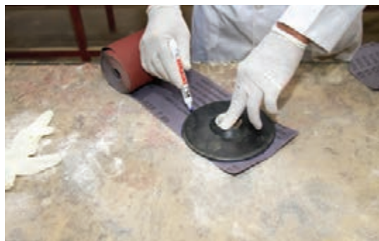
شکل ۲۹- ترسیم گردی دیسک روی سنباده
