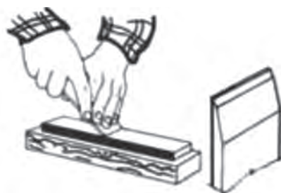
شکل ۲- تیز کردن مغار با سنگ نفت
