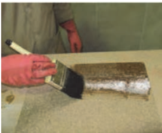
شکل ۶- روغن اندود کردن با روغن الیف و قلم موی پهن
