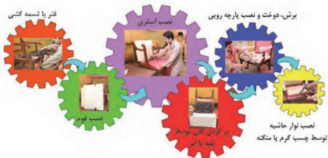
شکل ۲- مراحل اجرای رویه کوبی
