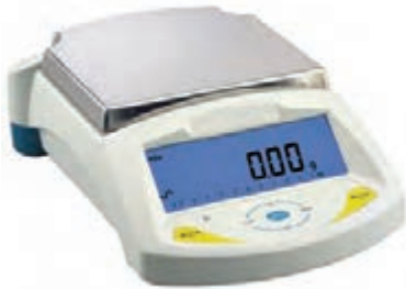
شکل ۳- وزن نمونه به وسیله ترازو با دقت 0.01 گرم
