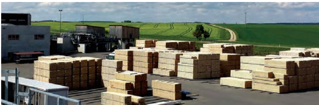
شکل ۱۱- نحوهٔ قرارگیری دسته‌بندی‌ها و خیابان‌های یارد
