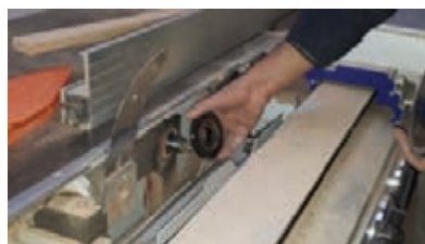
شکل ۶۲- باز کردن مهره و فلنج جلوی تیغه
