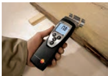
شکل ۶- دستگاه رطوبت سنج نوع دی الکتریک
