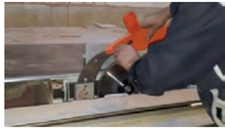
شکل ۶۷- بستن حفاظ و کاور روی تیغه ااره
