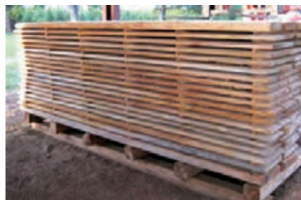
شکل ۱۳- روش چوب‌دستک‌گذاری در دسته‌های چوب
