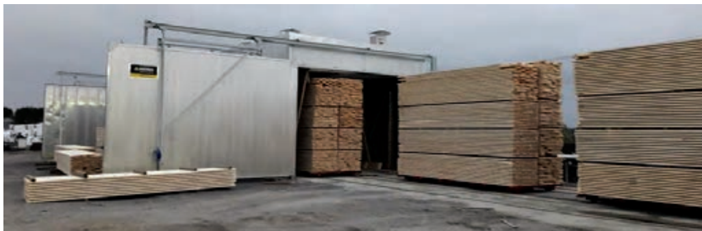
شکل ۶۵- بارگیری دسته‌بندی‌های چوب به طریق طولی
