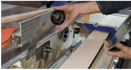
شکل ۶۳- بررسی فلنج پشت تیغه ااره
