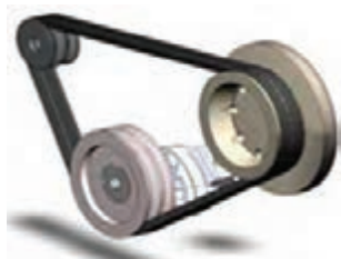
شکل ۵۳- نمونه ای از سیستم انتقال نیرو به صورت چرخ و تسمه
