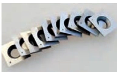
شکل ۲۵- تیغه‌های قابل تعویض که به جای تیغه‌های سراسری روی توپی رنده قرار می‌گیرد
