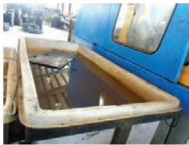
شکل ۷۵- حوضچه آب کنار دستگاه تزریق
