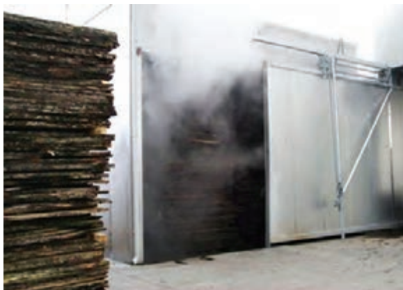
شکل ۶۹- خروج چوب‌های خشک شده از کوره
