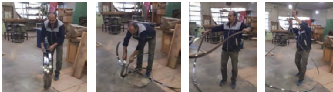
شکل ۱۹- روش جمع کردن تیغه اره نواری
