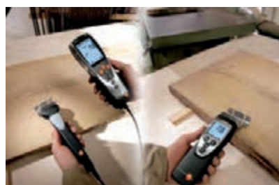
شکل ۶- دستگاه رطوبت سنج نوع دی الکتریک
