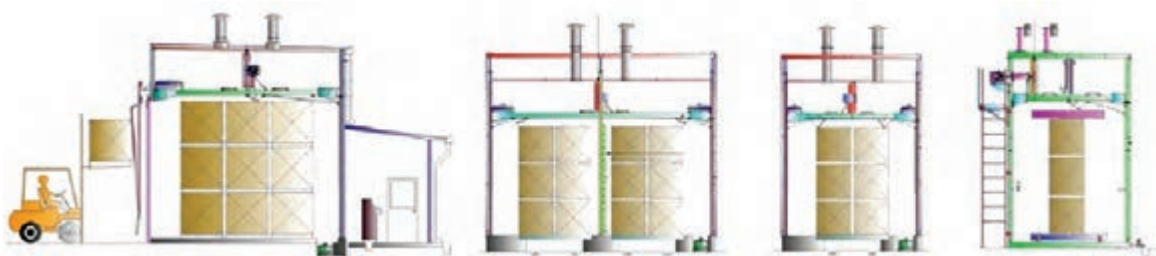
شکل ۲۱- اندازه‌های مختلف کوره حجره‌ای (اتاقکی)
