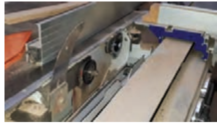
شکل ۶۳- بررسی فلنج پشت تیغه ااره
