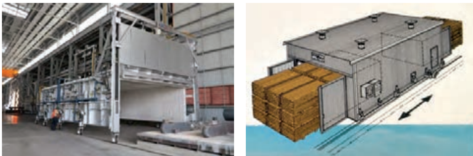
شکل ۶۷- نمونهٔ کوره‌های متحرک و سیستم عملکرد آن
