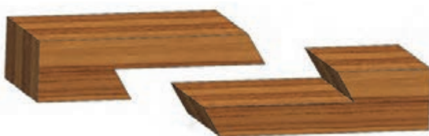
شکل ۳۸- اتصال طولی نیم و نیم
