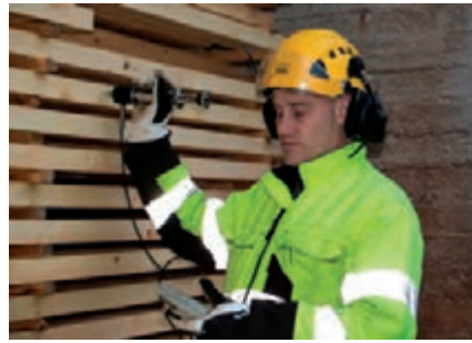
شکل ۵۰- مشخص کردن دمای تر و خشک با لوازم دستی
