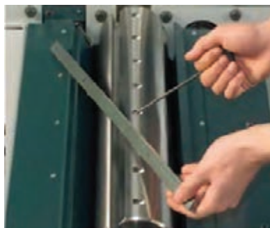
شکل ۲۷- روش تعویض تیغه رنده و نحوه قرار گرفتن تیغه و استقرار آن روی توپی
