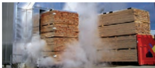
شکل ۶۴- اصول دسته‌بندی چوب روی واگن
