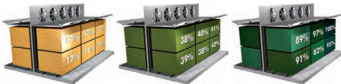
شکل ۶۸- مراحل مختلف خشک کردن چوب در کوره
