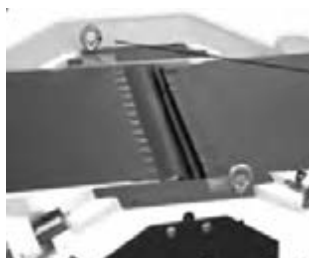
شکل ۲۶- موقعیت توپی رنده بین صفحات ورودی و خروجی ماشین رنده کف رند
