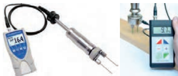
شکل ۷- دستگاه رطوبت سنج نوع مقاومت الکتریکی
