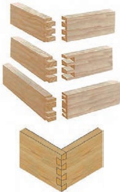
شکل ۲۶- نمونه‌هایی از اتصال گوشه‌ای دم چلچله با زبانه‌های مختلف
