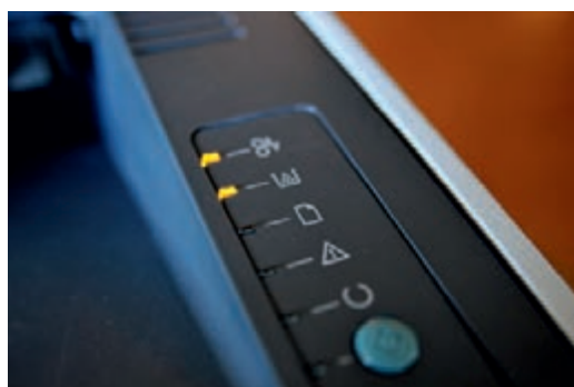
شکل ۱-۲۹- چراغ‌ها کلیدهای یک نمونه پرینتر
