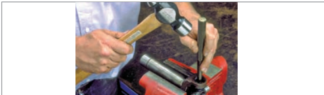
شکل ۲۱-۳- مراحل باز کردن اجزای گاردان
