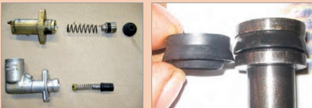
شکل ۲۱-۱- الف - نشتی داخلی در مدار هیدرولیکی
