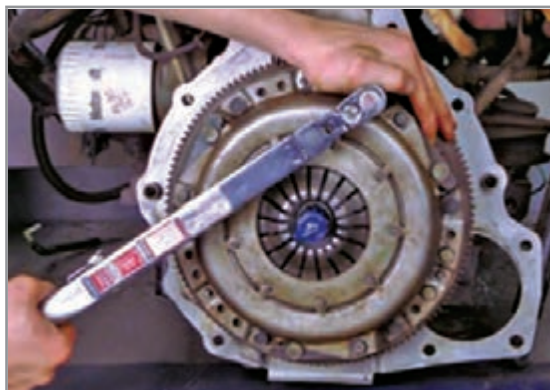
شکل ۱-۳۹- روش به گشتاور رساندن پیچ‌های دیسک کلاچ
