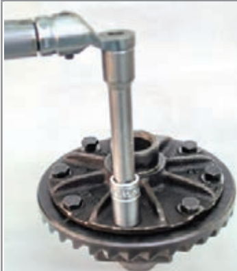
شکل ۵۰-۴- بستن پیچ‌های کرانویل
