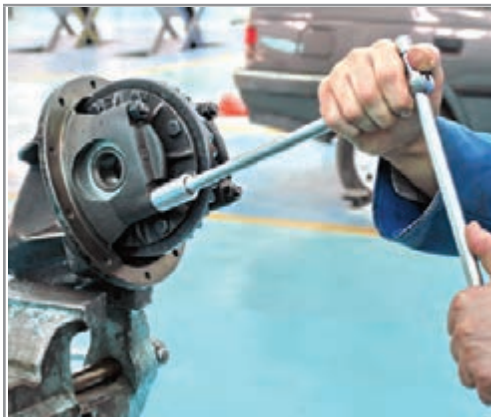
شکل ۵۳-۴- بستن کپه یاتاقان‌ها
