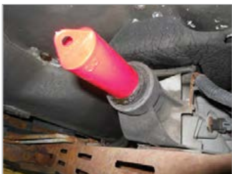
شکل ۱۹-۳- استفاده از ابزار مخصوص کورکن
