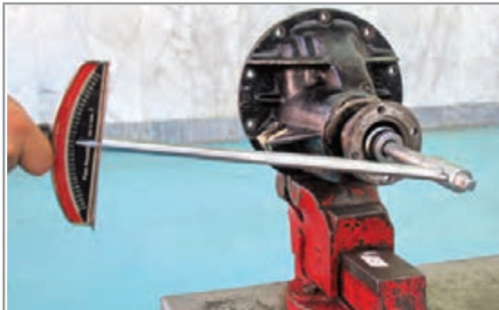
شکل ۴۸-۴- (ب) تعیین گشتاور پیش بار با گشتاورسنج
