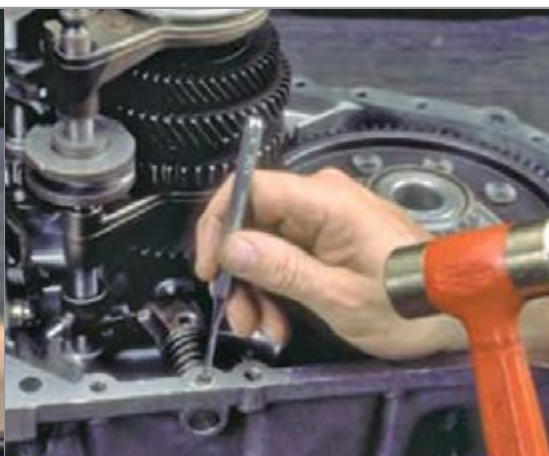
بیرون آوردن پین نگهدارنده اهرم تعویض دنده
