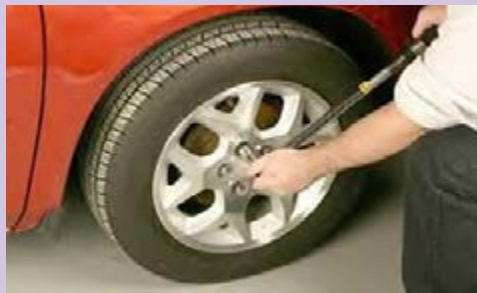
شکل ۵- گشتاور لازم برای سفت کردن چرخ
